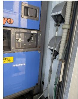
助手席にあるインバータパネルをONにすることで、サブバッテリー経由のインバータが稼働して庫内ブレーカに通電されます。発電機や外部電源からの電源の場合は、直にブレーカへと流れます。
